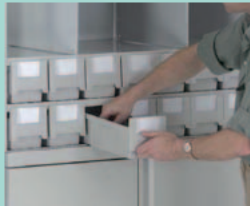
El almacenamiento de pequeñas piezas se realiza en cajones de plástico con separadores internos.
